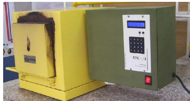
Fig. 8 Empotrado del CTC-f1 al horno.
