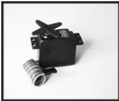
Fig. 8 Motor T-PRO SG5010, servomotor para el accionamiento de las articulaciones.
