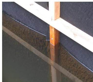
**Figura 4** Formación de biopelícula en la superficie opuesta del geotextil
