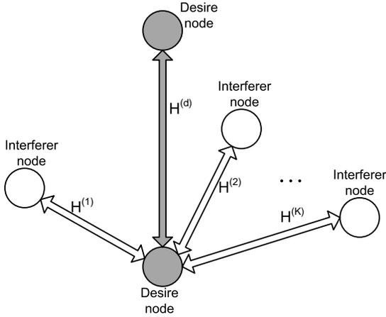
Fig. 2. MIMO ad hoc communication scenario.
