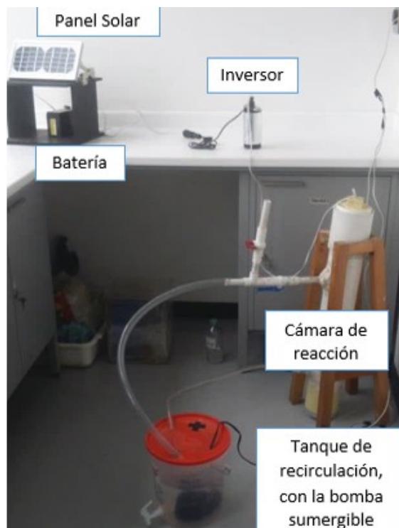
Figura 2. Conexión general del reactor foto-oxidativo.
