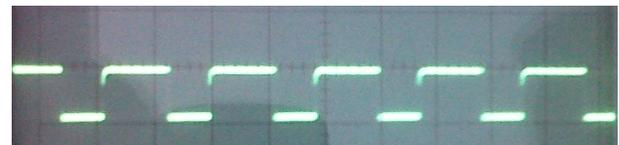
Imagen 1. Señal entregada por el fit-flop, 5V/Div en el eje vertical y 10ms/Div en el eje horizontal.
