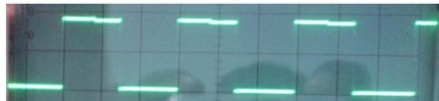
Imagen 2. Señal en el colector Q6, 5V/Div en el eje vertical y 10ms/Div en el eje horizontal.
