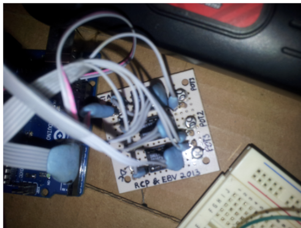
Figura 17. Interfaz con potenciómetros digitales para comunicar el computador anfitrión con el control de radio frecuencia.
