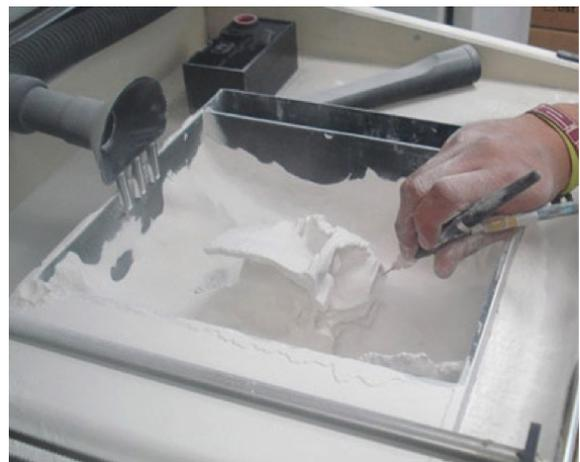
Fig. 5. Se retiran los residuos de polvo con una pistola de aire.
