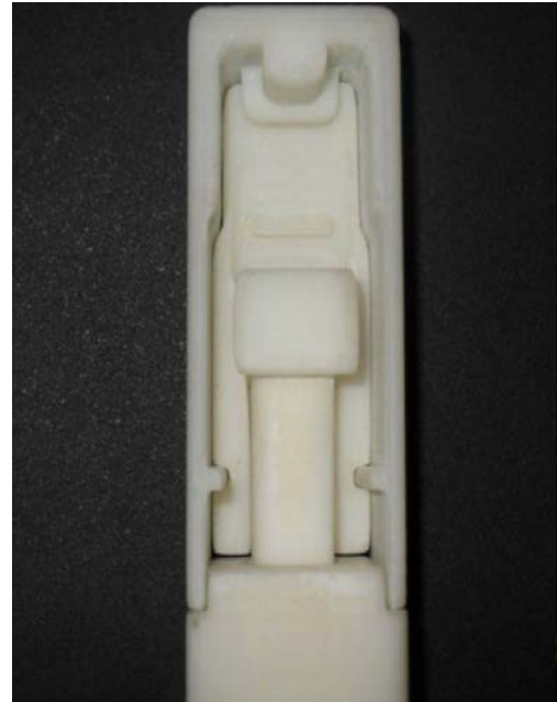
Fig. 22. Impresión en 3D de los elementos que conforman al dispositivo.
