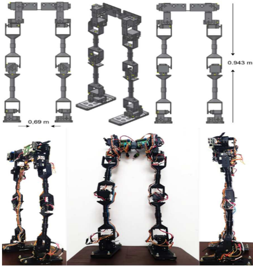
Figura 2: Modelo CAD del robot bípedo y prototipo real.
